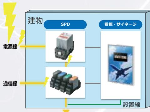
SPD を経由してアースなどに流れるため電源線や通信線が繋がっている状態でも電源・通信機器を安全に守ることができます。
